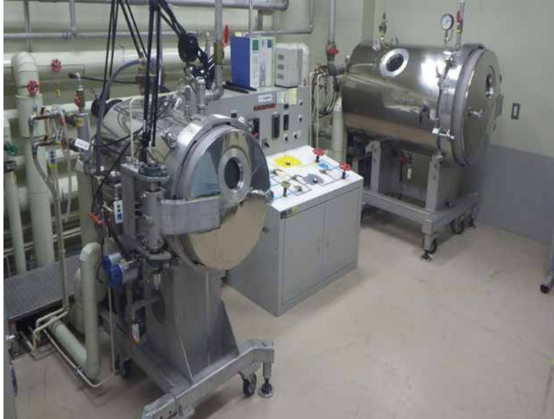
図3 動物用高気圧チャンバー 防衛医学研究センター 特殊環境衛生研究部門 設計：パロテックハニユウダ、富士電機、中山商事 10気圧まで加圧可能
